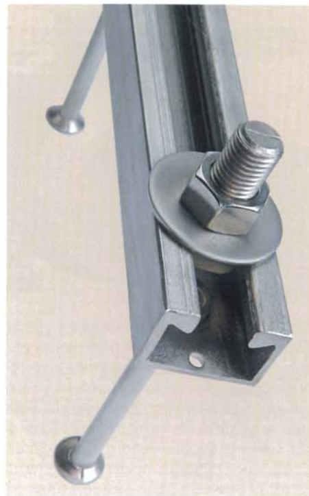
Jordahl® Ankerschienen JTA W gewährleisten die sichere Befestigung von Ausrüstungen und Schachtführungen. Sie sind für dynamische Belastungen zugelassen und können zentrischen Zug, Schrägzug und Querkzug aufnehmen.
